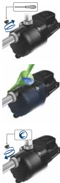
Фиг. 8 Обезвъздушаване на помпата
