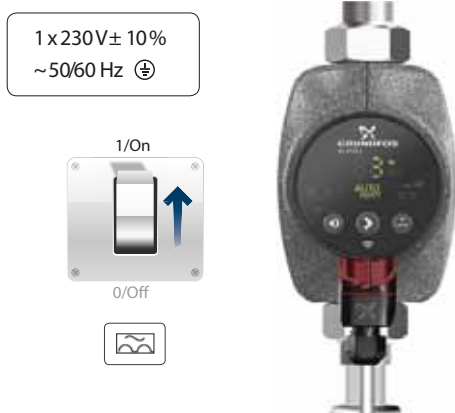
Фиг. 7 Стартиране на помпата
