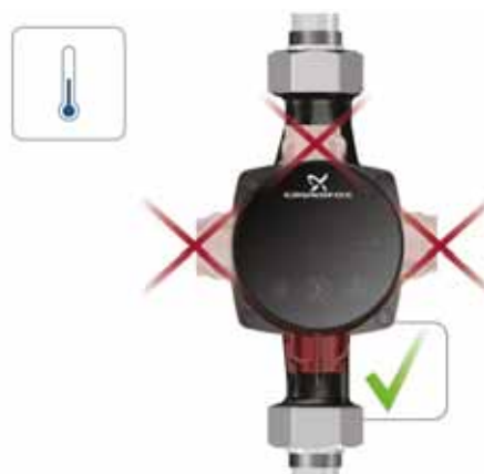
Фиг. 4 Разположение на блока за управление, климатични системи и системи за студена вода
